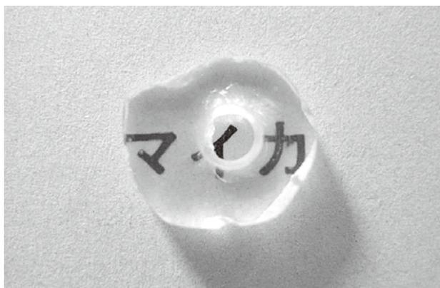
図1 透明なマシナブルマイカ結晶化ガラス
