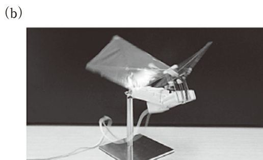
図5. (a) 羽ばたき機構、(b) モータを動力源とする試作機。
