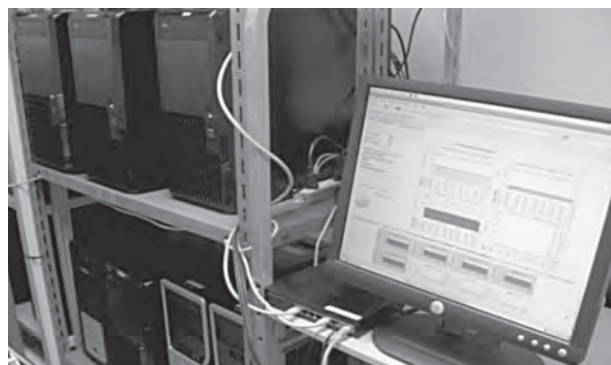
図4 並列処理によるコンピュータシミュレーションを実行するためのPCクラスタ
