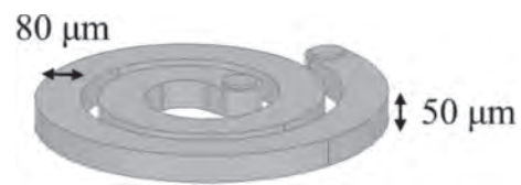
図5 2 turn 円形平面スパイラルインダクタの解析モデル
