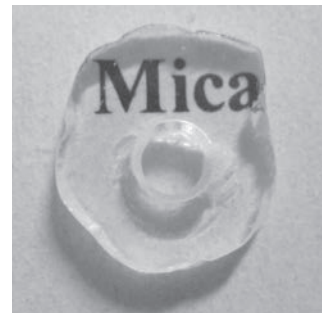
図4 機械加工ができる透明なマイカ結晶化ガラス
