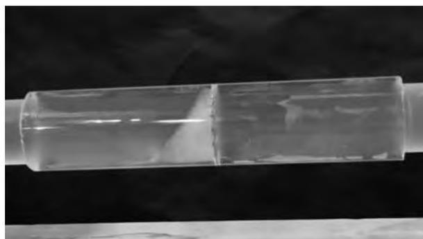
図6 目開き1mmのメッシュに堆積する氷粒子の様子
