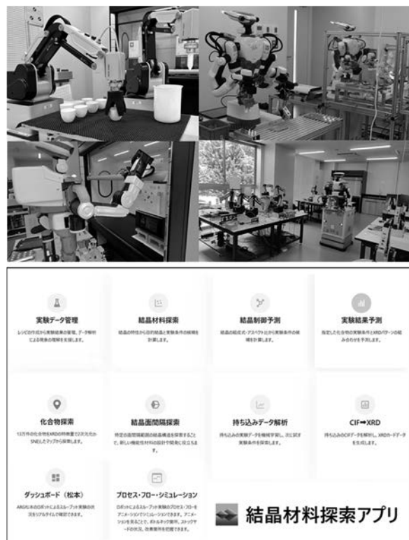
図3. ARG 共創研究センターで稼働する自律実験ロボットシステムと、実験を支援する独自開発アプリ
